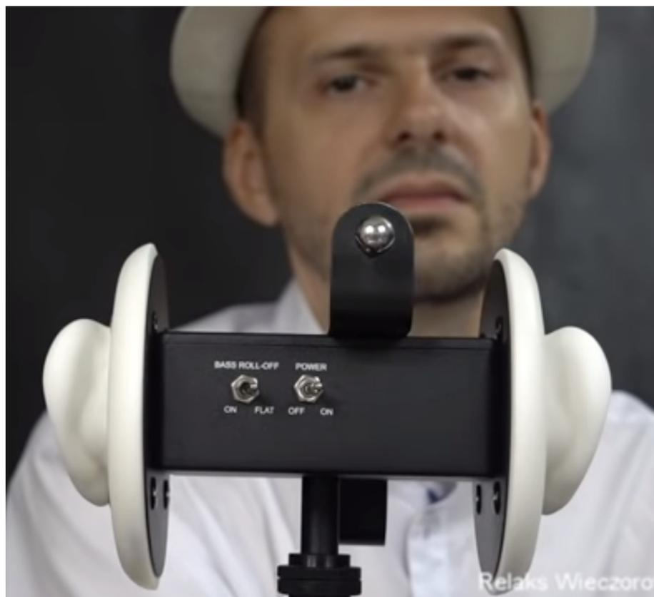
**Ryc. 2.** Mikrofon binauralny z nakładkami w kształcie ucha<sup>26</sup>.
